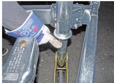
Mechanik der Feststellbremse ölen
