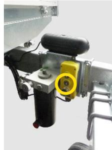
1. Betätigen Sie "AB" und halten den Knopf gedrückt, bis die Kipplager auf den Kugelbolzen einrasten.
