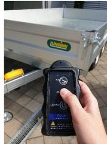
1. Betätigen Sie die Funkfernbedienung und halten Sie den Knopf gedrückt, bis die Kipplager auf den Kugelbolzen einrasten.
