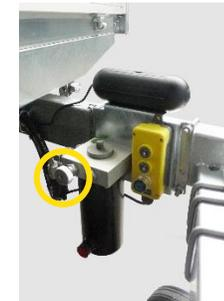
1. Öffnen Sie langsam das Handsenkventil und warten, bis die Kippklammer auf den Kugelbolzen einrastet.
