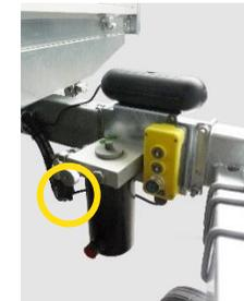
1. Schließen Sie das Handsenkventil der Notpumpe Pumpspl.
