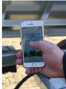
1. Betätigen Sie die Absenken-Taste und halten den Knopf gedrückt, bis die Kippplager auf den Kugelbolzen einrasten.
