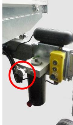
1. Schließen Sie das Handsenkenventil der Notpumpe Pumpless.
