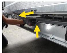
2. Öffnen Sie den klappbaren Kennzeichenhalter. Drücken Sie diesen hierzu leicht nach oben.
