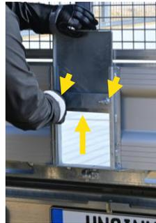
1. Lösen Sie die Flügelschrauben.
