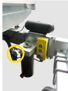
1. Öffnen Sie langsam das Handsenkventil und warten bis die Kipplager auf den Kugelbolzen einrasten.
