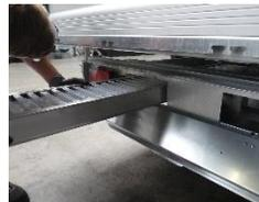
3. Schieben Sie die Auffahrschienen in die Rampenschächte bis zum Anschlag.
