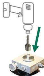
2. Versehen Sie Ihren Akkuschauber mit einem passenden Steckschlüssel (SW13, im Lieferumfang enthalten), stellen ihn auf die Stufe bis 2.000 U/min ein und treiben die Einheit im Rechtslauf an.
