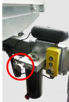
1. Schließen Sie das Handsenkenventil der Notpumpe.
